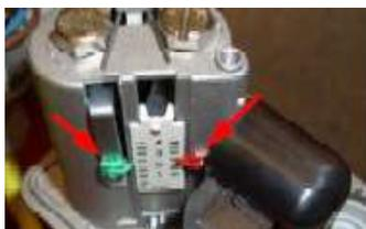
Рис. 66 Манометрический выключатель
