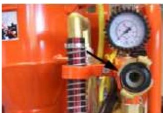
Рис. 62 Фильтр из латуни на входном патрубке для воды.
