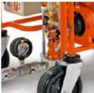
Рис. 21 Манометр давления раствора
