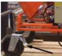
Рис. 16 Стояночный ролик (тормоз)
