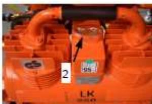
Рис. 35 Компрессор выключить
