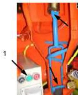
Рис. 40 Откидной фланец двигателя закрыть
