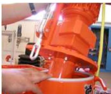
Рис. 39 Закрытие откидного фланца двигателя
