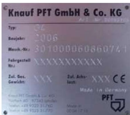
Типовой шильдик находится на внутренней стороне ящика с инструментом и содержит следующие данные:
