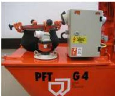
Рис. 23 Перегрузочная камера
