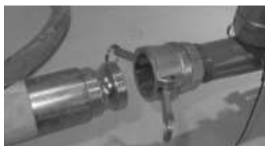
Рис. 25: Отсоединение шланга подачи раствора
