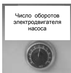
Рис.8: Режимы работы. Число оборотов электродвигателя насоса
