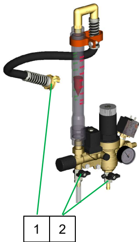
Рис. 86: Отсоединение подачи воды
