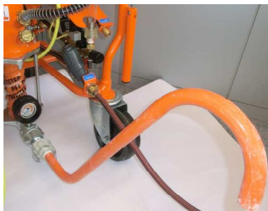
Рис. 45: Труба для контроля консистенции раствора
