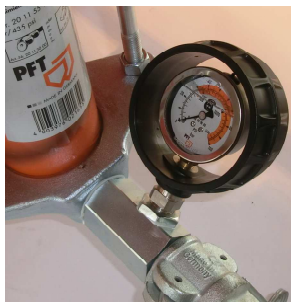
Рис. 39: Манометр давления раствора
