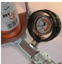
Рис. 27: Манометр давления раствора
