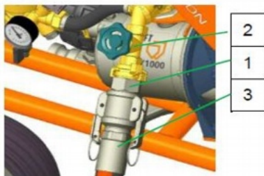
Рис. 52: Подготовка шланга для подачи раствора
