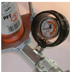
Рис. 42: Манометр давления раствора
