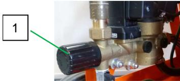
Проверить настройку редукционного клапана:
