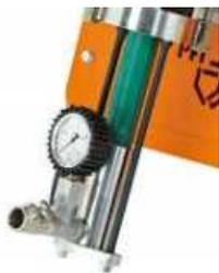
Рис. 48: манометр давления раствора
