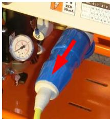
Рис. 111: Демонтаж соединительного кабеля
