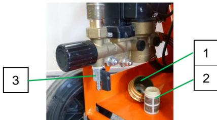
Рис. 39: Грязеулавливающий сетчатый фильтр
