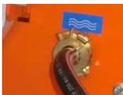
Рис. 1: Подключение воды
