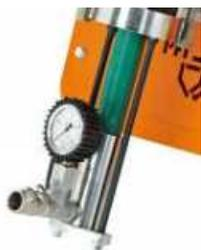
Рис. 71: манометр давления раствора
