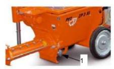
Рис. 36: Открыть очистную крышку
